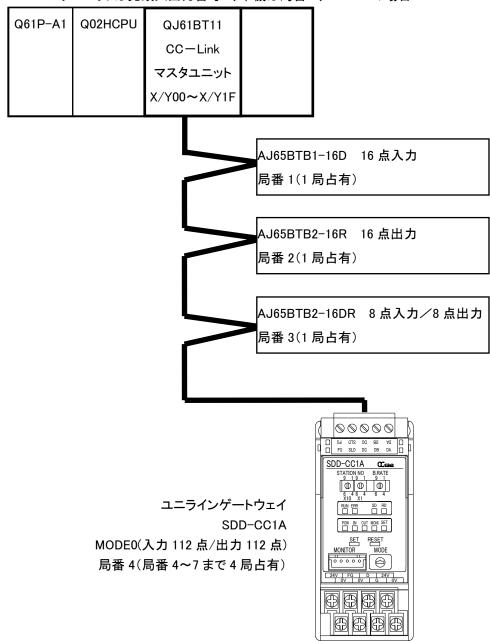
CC-Link でマスタ局とリモート I/O 局、リモートデバイス局、ローカル局間で交信する為にはパラメータを設定し、データリンクを開始する必要があります。
