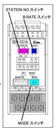
"5"以上にセットすると ERR, POW, IN, OUT, MONI, SET LED が点灯し伝送停止します。
