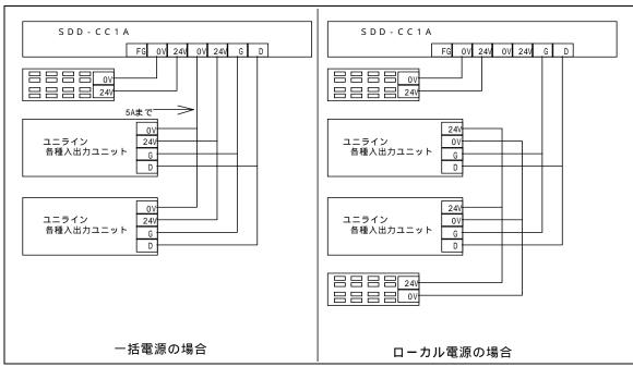
一括電源の場合本機内を通じて供給することになるため、ターミナルに供給する 24V 電源はセンサや電磁弁など負荷用を含め 5 Aまでとしてください。
