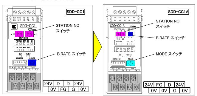
従来品 SDD-CC1 からの置換えの場合、動作モード MODEO(SDD-CC1 互換モード)を選択すればプログラムそのままでご使用いただけます。
