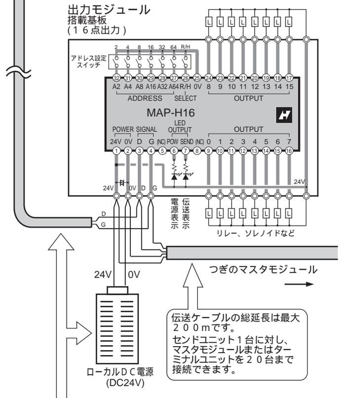
遠隔部分での電源電圧降下には図のようなローカル電源方式を考慮してください。
