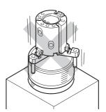
把持したワークを移動したり反転するときに、移動 端でジグなどにワークを押しつける。
