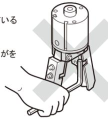
チャックを構成する部品が飛び散り、けがをする恐れがあります。
