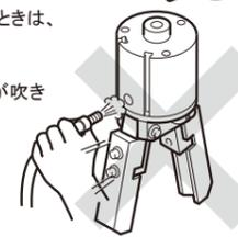
エアチューブが跳ね上がったたり、チャックが吹き飛んだりして、けがをする恐れがあります。
