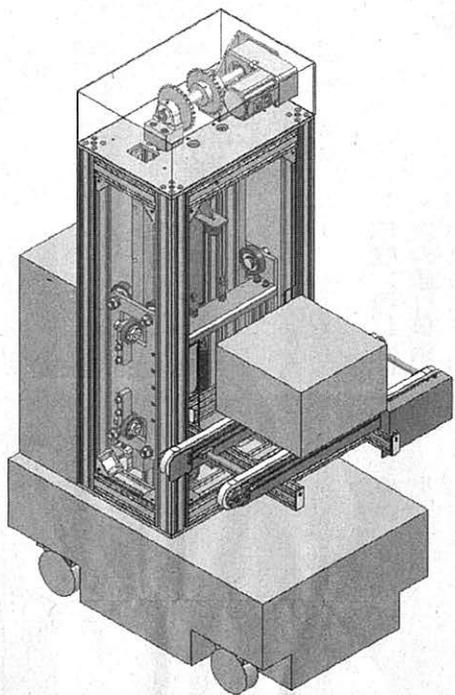
AGVに搭載する積み降ろしシステム（イメージ）
