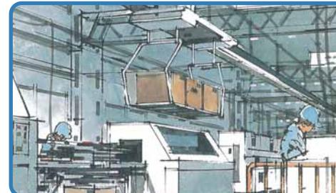
指定ケーブルをもたないユニラインなら、トロリー線を伝送路として用いることができます。カーテンレールの配線本数、重量とも大幅に減少でき、断線トラブルが少なくなります。
