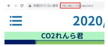
4-3-1-1 IP アドレス割付が DHCP ではない(固定 IP)場合 出荷時の IP アドレス設定は DHCP (IP の自動取得) になっています。 接続されるネットワークに DHCP サーバがない場合、れんら君の IP アドレスは「169. 254. \*. \*」 (「\*」は 1~254 の数字) になります。
