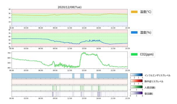
温度(℃) : 0~40℃の範囲に折れ線グラフで描画します。 湿度(%) : 30~80%の範囲に折れ線グラフで描画します。 CO2(ppm) : 二酸化炭素濃度値を折れ線グラフで描画します。
