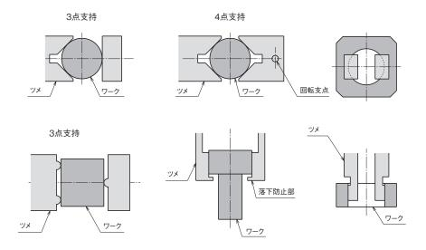
■長尺物や大きなワークを安定して把持するには重心を掴むことが前提条件です。 長いワークは長手方向の重心位置を把持しますが、それでも不安定な場合、エアチャックのサイズを大きくする、2個使用するなど の対策を施してください。
